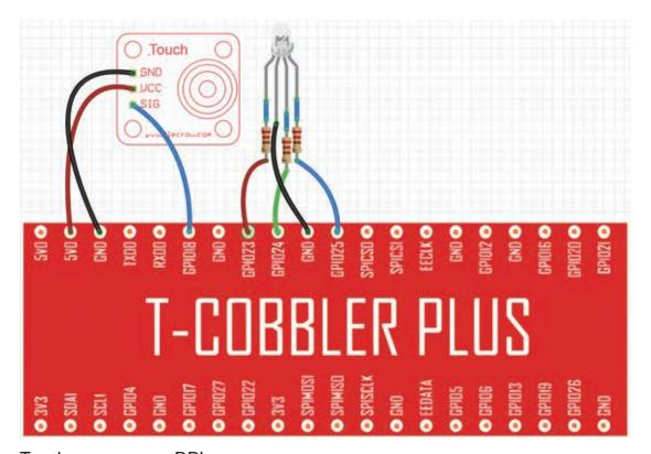
**RPI** Touch sensor **GND GND** VCC 5V0 -> SIG **GPIO18 RGB LED** R GPIO23 GND **GND** -> G GPIO24 В **GPIO25**
