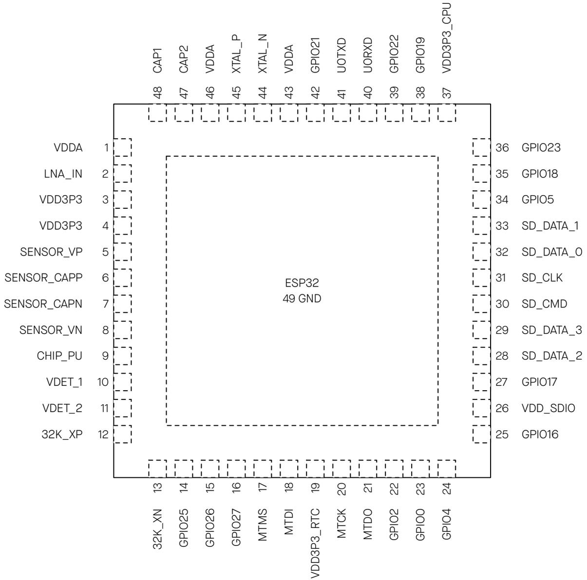
Figure 2-1. ESP32 Pin Layout (QFN 6\*6, Top View)
