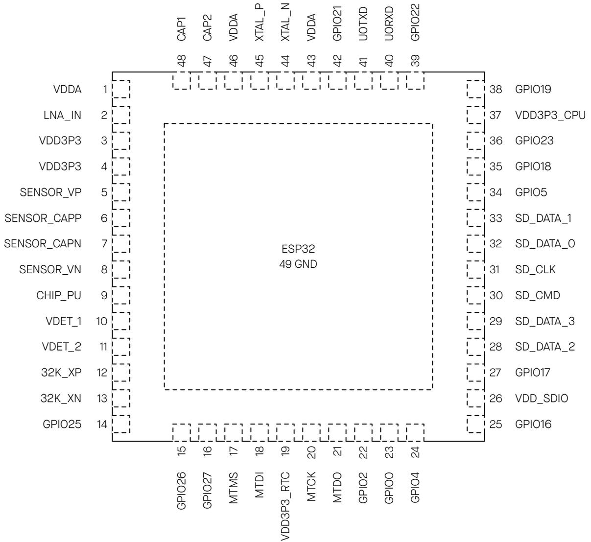
Figure 2-2. ESP32 Pin Layout (QFN 5\*5, Top View)
