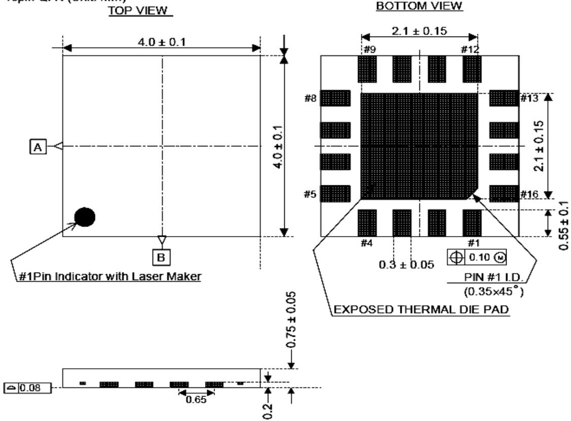
图20 QFN-16 封装尺寸
