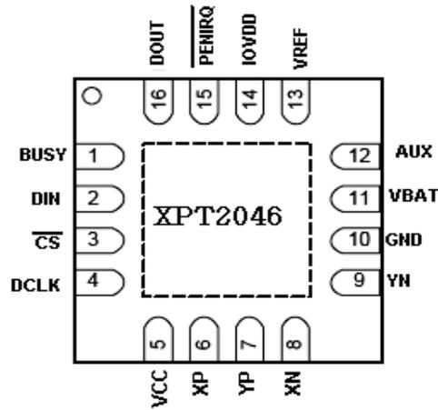
图3 XPT2046 的 QFN-16 封装管脚
