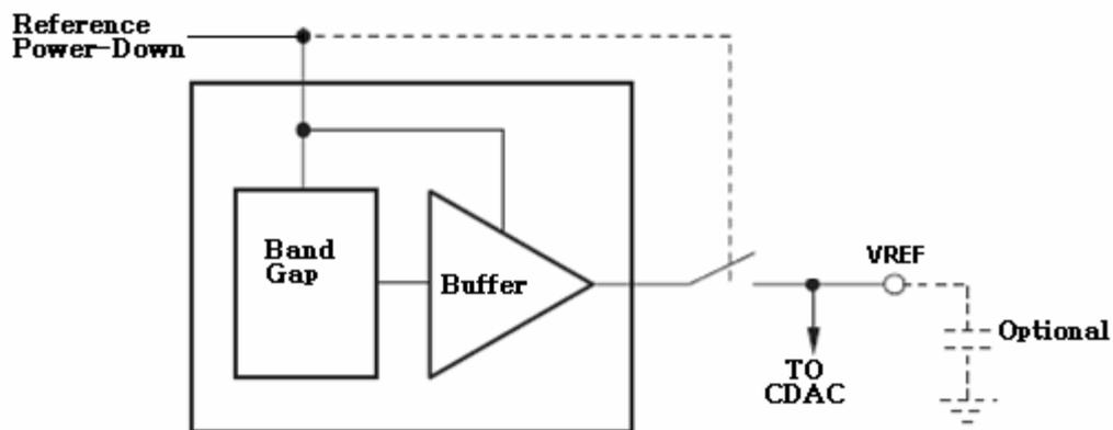
图8 内部电压源示意图
